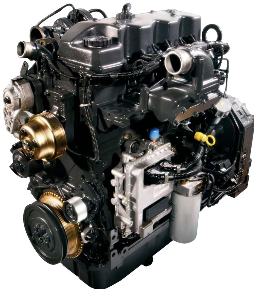
В этом двигателе CNH с системой впрыска Common Rail используются новейшие технологии, разработанные для повышения производительности с одновременным снижением потребления топлива и уровня загрязнения окружающей среды.
